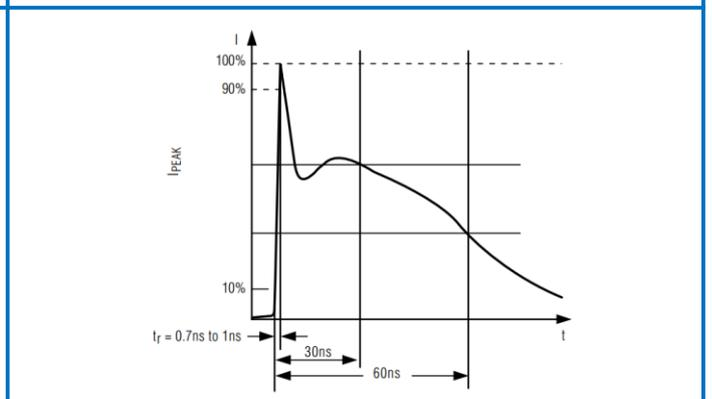
图 7 IEC 1000-4-2 ESD 测试的电流波形
