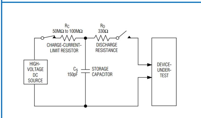
图 6 IEC 1000-4-2 ESD 测试模型
