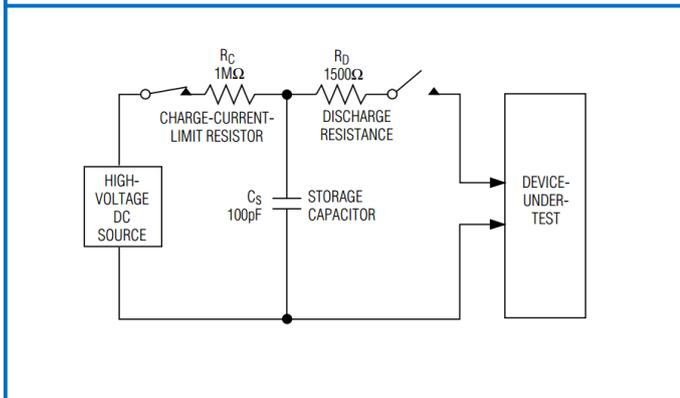
图 4 人体模式 ESD 测试模型
