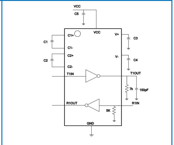
图 3 最大摆率测试电路
