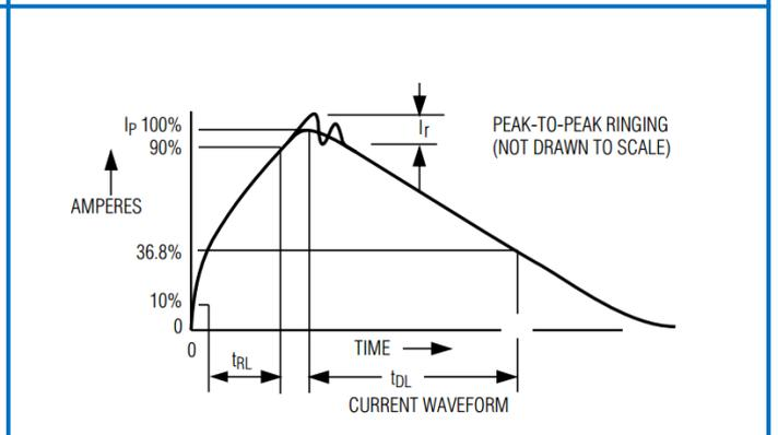
图 5 人体模式电流波形
