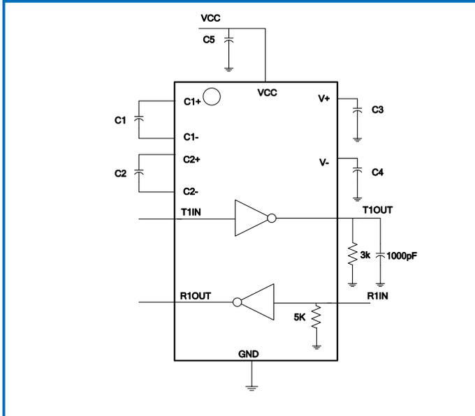
图 2 最小摆率测试电路
